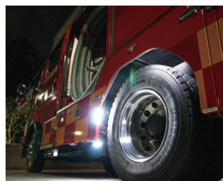
インナーフェンダーにLEDを装着した消防車
