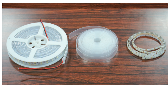
使用した材料左から熱伸縮テープ加工後のLEDテープ、熱伸縮チューブ、LEDテープ(加工前)
