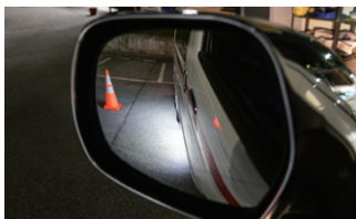
LEDテープ装着後の点灯
